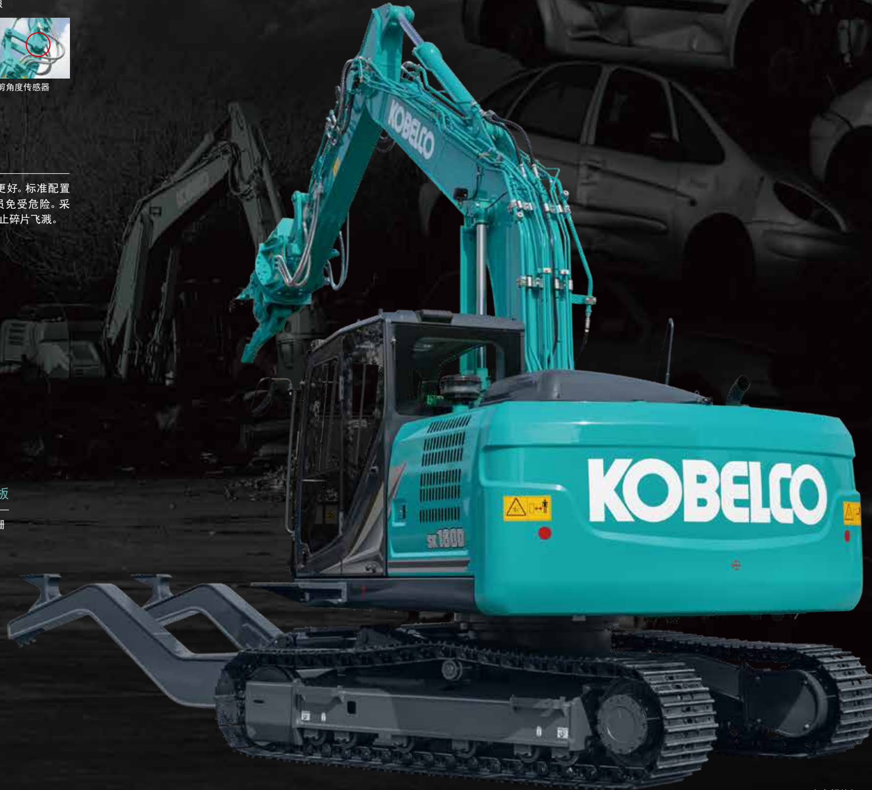
SK160D汽车解体机
