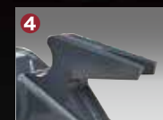
拔线器 爪形，适用于拆解线束
