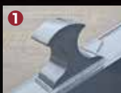
折弯器（多功能解体机） 便于折弯长条材料
